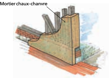
L'isolation thermique de l'ossature en pan de bois peut être intégrée dans l'entre colombage et par l'intérieur sous forme de mortier.
